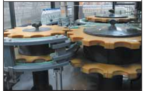
Typischer Kunststoffformatsatz an einer Getränkeabfüllanlage
