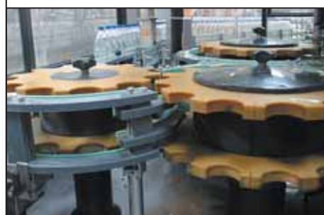
Een typisch set van vormdelen voor een bottelmachine
